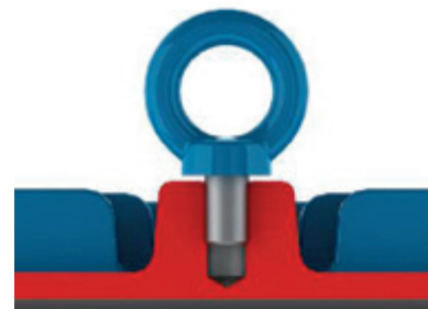
Bild 4.2 - Falsche Befestigung der Transportösen
