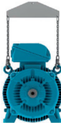
Рисунок 4.7 - Использование распорной траверсы при подъеме
