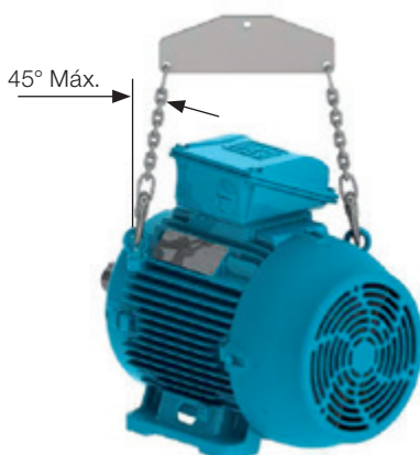
Figura 4.4 - Ángulo máximo resultante para motores con dos o más cáncamos de elevación
