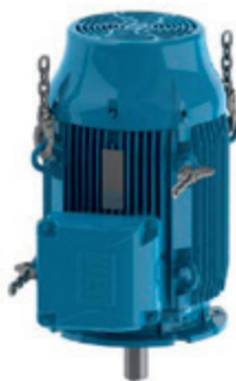
Рисунок 4.18 - Установка второй пары рым-болтов
