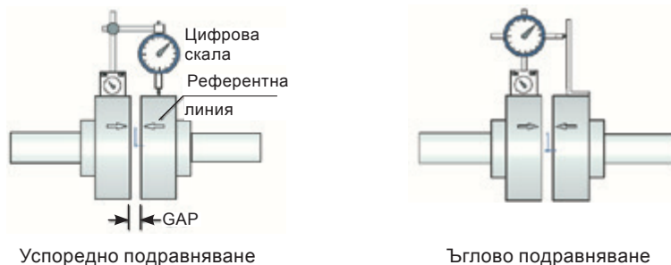
Фигура 6-11 – Подравняване с уреди с цифрова скала
