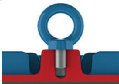
Фигура 4-1 – Правилно затягане на болта с халка
