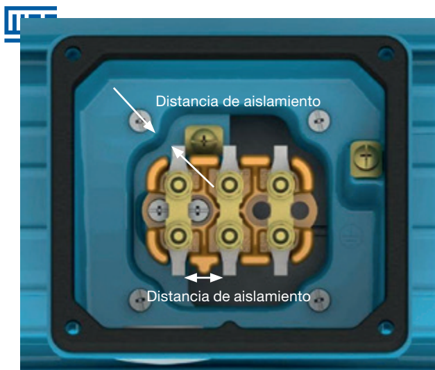
Figura 6.15 - Representación de la distancia de aislamiento
