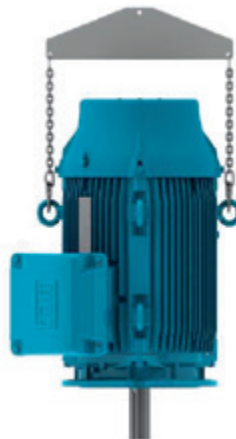
Рисунок 4.8 - Подъем электродвигателей вертикальной установки
