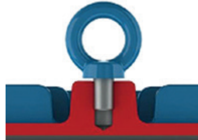
Figurii 4.2 - Strângerea incorectă a unui șurub cu ochi
