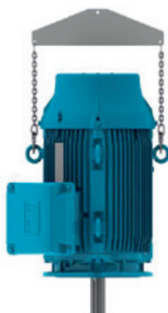
Figura 4.8 - Içamento de motores verticais
