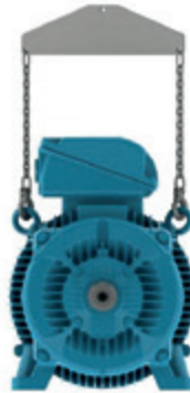
Figurii 4.7 - Utilizarea unei bare distanțier pentru ridicare
