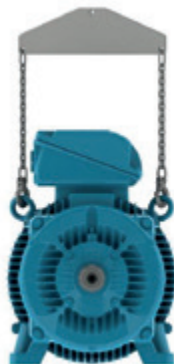
Фигура 4-7 – използване на раздалечителен елемент
