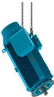
Рисунок 4.15 - Подъем электродвигателей серий HGF и W50 за рым-болты на глухом торце
