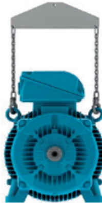
Bild 4.7 - Einsatz eines Querbalkens zum Heben
