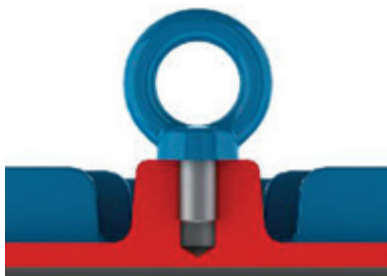
Bild 4.1 - Richtige Befestigung der Transportösen
