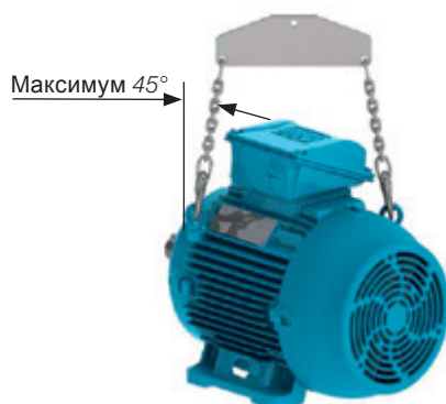
Рисунок 4.4 - Максимальный угол отклонения [подъемных строп] для двигателей с двумя рым-болтами и более
