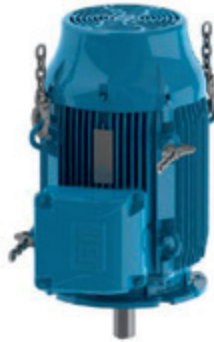
Figura 4.18 - Instalación del segundo par de cáncamos
