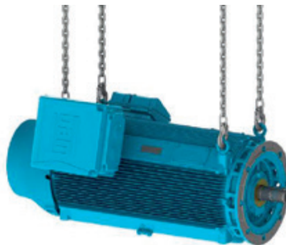
Bild 4.13 - Den Motor der Baureihe HGF und W50 an den vier seitlich angebrachten Transportösen mit zwei Hebevorrichtungen heben
