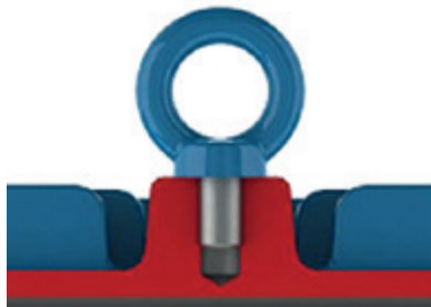
Figurii 4.1 - Strângerea corectă a unui șurub cu ochi
